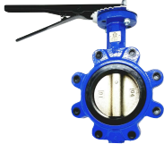
VALVULA MARIPOSA/ LUG CUERPO HIERRO DUCTIL DISCO HIERRO DUCTIL ASIENTO EPDM
