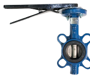
VALVULA MARIPOSA CUERPO HIERRO DUCTIL DISCO CF8 ASIENTO EPDM
