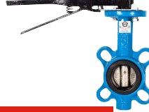
VALVULA MARIPOSA CUERPO HIERRO DUCTIL DISCO HIERRO DUCTIL ASIENTO EPDM
