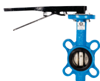
VALVULA MARIPOSA 2"-10" CUERPO HIERRO DUCTIL DISCO HIERRO DUCTIL ASIEN TO BUNA
