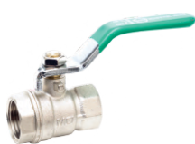
VÁLVULA ESFERA DE LATÓN 300 LBS WOG 1/2" - 2"
