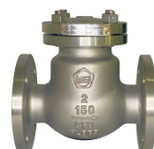
VÁLVULA CHECK BRIDADA 2"-8" TIPO COLUMPIO CON ASIENTO INOXIDABLE 150 LBS CF8
