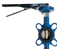
VALVULA MARIPOSA 2"-12" CUERPO HIERRO DUCTIL DISCO CF8 ASIEN TO EPDM
