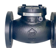
VÁLVULA CHECK BRIDADA 2"-8" TIPO COLUMPIO CON ASIENTO DE BRONZE 125 WOG
