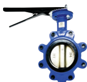
VALVULA MARIPOSA/ LUG 2"-10" CUERPO HIERRO DUCTIL DISCO HIERRO DUCTIL ASIEN TO EPDM
